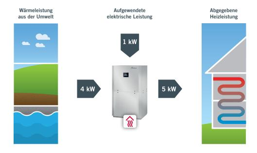
Wärmepumpen zeichnen sich, wie kein anderer Wärmeerzeuger, durch besonders hohe Energieeffizienz aus. Denn nur rund 20 % der Energie werden als elektrische Energie zugeführt, die restlichen 80 % holt die Wärmepumpe aus der Umwelt.
