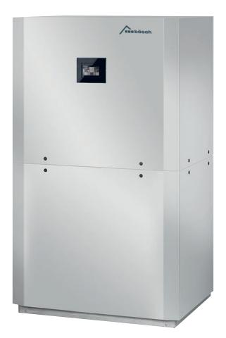
Mit der Sole/Wasser-Wärmepumpe SWP erhalten Sie ein vollwertiges Heizsystem für Wohlfühlwärme und Trinkwarmwasser. Mit bis zu 70 °C Vorlauftemperatur eignet sich die Wärmepumpe für alle bestehenden Verteilersysteme (Radiatoren und Fußbodenheizung).
